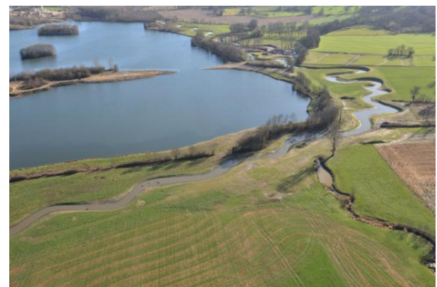
Figure 20 : Exemple de la restauration de la Veyle par dérivation d'une gravière par création d'un nouveau lit (2010, Syndicat de la Veyle Vivante – Vital)
