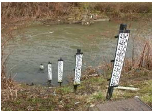
Chaque station possède un ou plusieurs capteurs (appareil mesurant une grandeur, hauteur ou débit).
